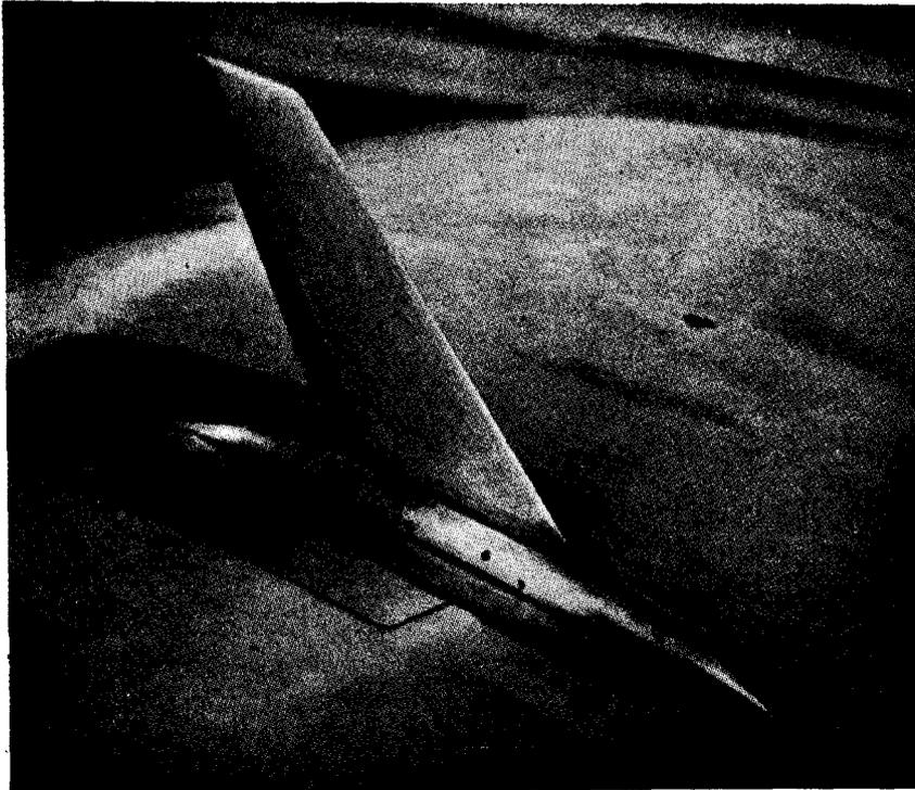
Fig. 2. — Modelo montado en la superficie convexa de un túnel de N. A. C. A. para experimentación transónica (*J. R. A. S.*, Julio 1949, pág. 645).
